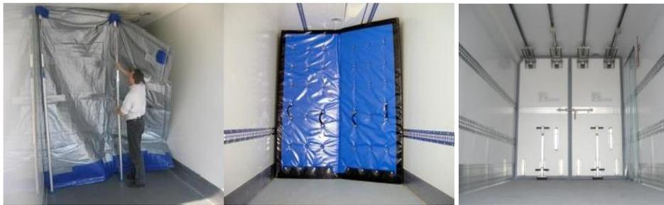
3. При сертификации транспортных средств с мультитемпературным режимом необходимо проводить оценку свойств разделительных стенок, позволяющих обеспечивать физическую и термическую изоляцию между смежными камерами внутри транспортного средства во время перевозки скоропортящихся пищевых продуктов.
