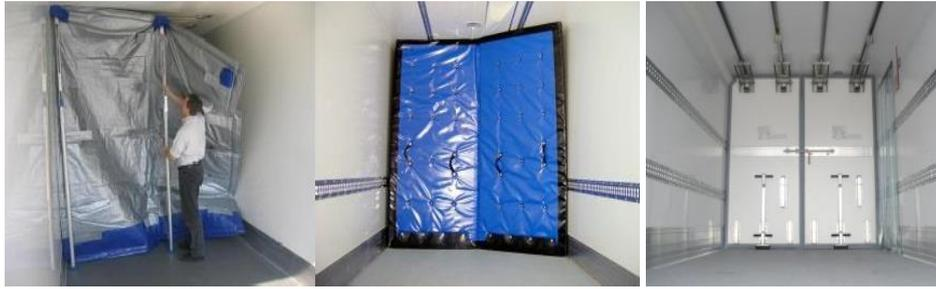
3. La certification d'un engin multi-températures nécessite d'évaluer la capacité des cloisons à maintenir une séparation physique et thermique des compartiments adjacents dans l'engin pendant le transport des denrées périssables.
