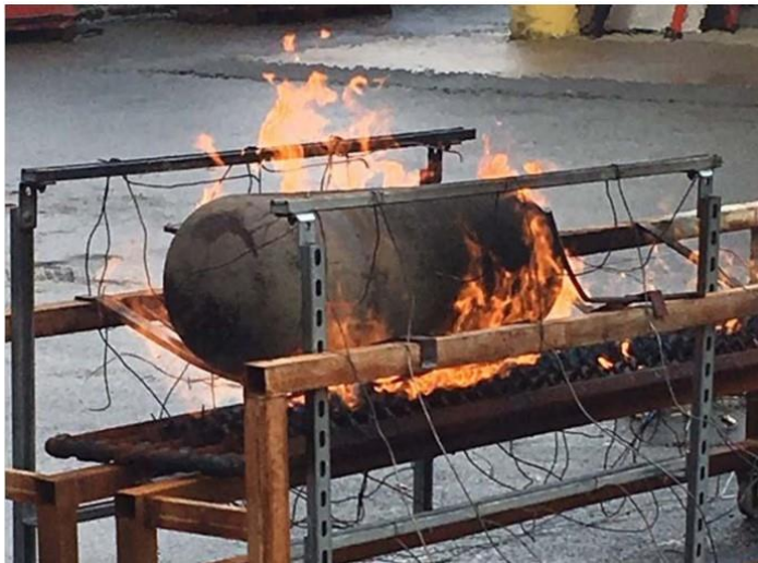
Рис. 13 Испытание резервуара на огнестойкость
