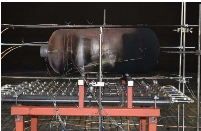
Рис. 18 Установка опытного баллона над горелкой для картирования тепловых режимов
