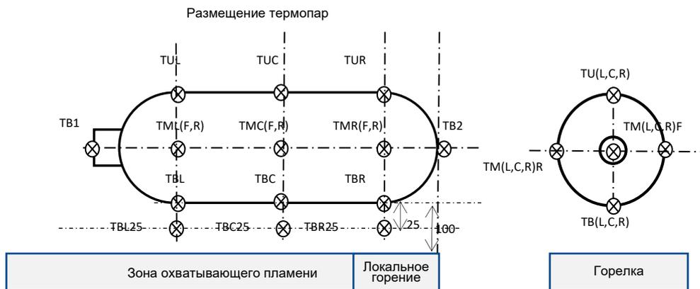
Для измерения значений температуры на опытном баллоне используются термопары типа К диаметром 3,2 мм (или меньше) с покрытием, размещенные на расстоянии 5 мм от поверхности резервуара и крепящиеся к ней при помощи хомутов или иным механическим способом. Точки замера температуры, показанные на рис. 5, означают следующее:
