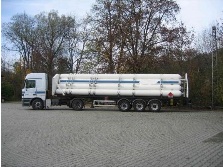
**II. Транспортное средство-батарея, сконструированное с использованием бесшовных стальных баллонов**
