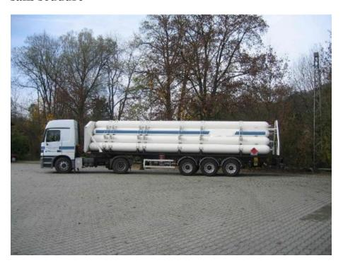
II. Véhicule-batterie construit avec des bouteilles en acier sans soudure
