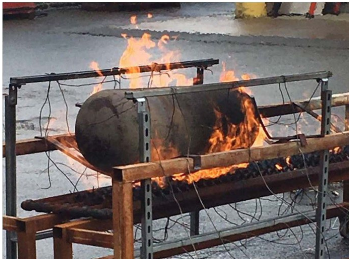
Рис. 13 Испытание резервуара на огнестойкость
