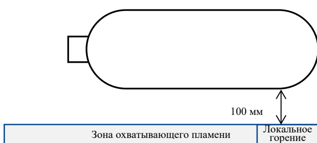
Рис. 8 Установка опытного баллона для целей предварительной проверки перед испытанием (вид сбоку)
