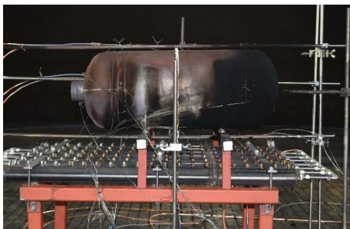
Figure 18 Réservoir d'essai préalable installé au-dessus du brûleur pour la cartographie thermique
