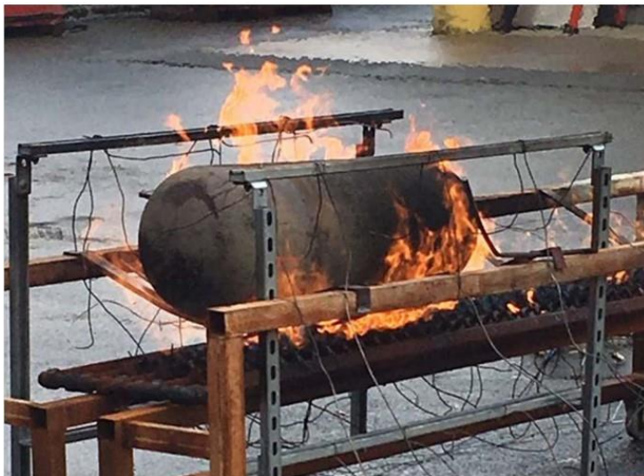
Figure 13 Essais de comportement au feu d'un réservoir
