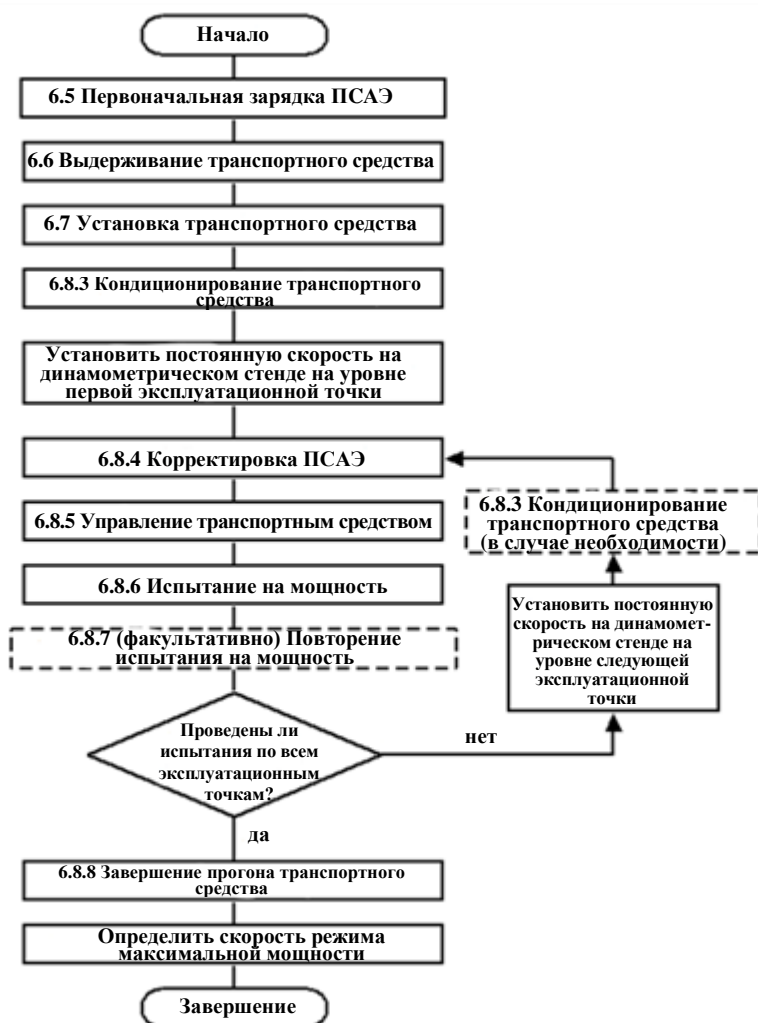
Рис. 30 Последовательность испытания для определения скорости режима максимальной мощности
