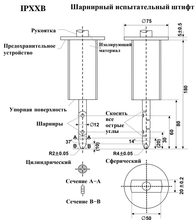
Рис. 3 Шарнирный испытательный штифт Щуп для проверки вероятности прикосновения (Размеры в мм)
