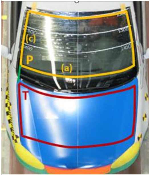
Рис. 14 Боковые границы зоны контрольного испытания накладки рамы
