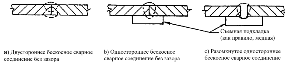
Рис. 1 Основные типы продольных стыковых сварных соединений
