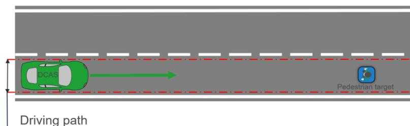
4.2.5.2.8.2. Essai prolongé : l'essai doit démontrer que le système ne modifie pas de manière déraisonnable la stratégie de contrôle d'un piéton immobile.
