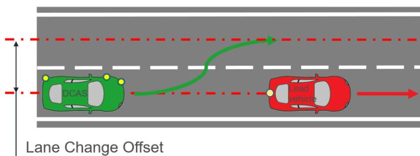
4.2.5.1.4.2. Essai prolongé : l'essai doit démontrer que le système est capable d'aider le conducteur à changer de voie en toute sécurité :
