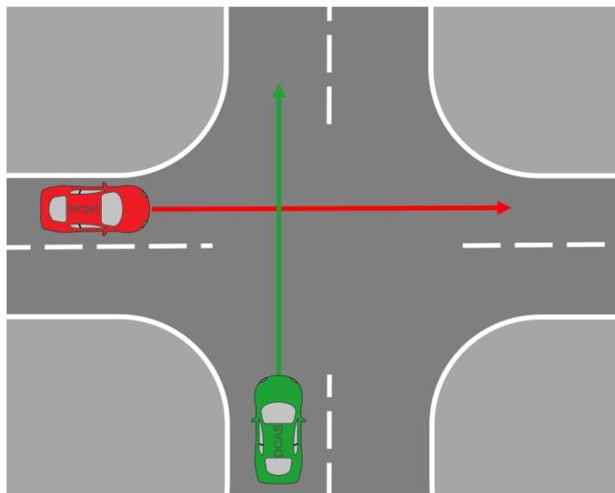
4.2.5.2.15.2. Essai prolongé : l'essai doit démontrer que le système ne modifie pas de manière déraisonnable la stratégie de contrôle pour une cible véhicule traversant qui roule en ligne droite à une intersection.
