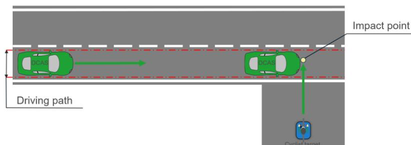
4.2.5.2.11.2. Essai prolongé : l'essai doit démontrer que le système ne modifie pas de manière déraisonnable la stratégie de contrôle d'une cible de bicyclette qui traverse.
