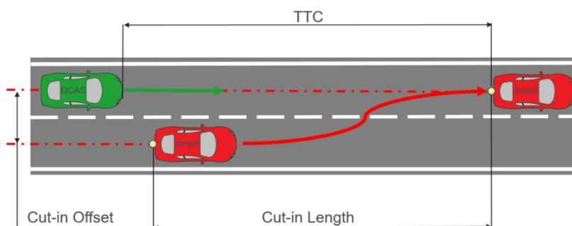
4.2.5.2.6.2. Essai prolongé : l'essai doit démontrer que le système ne modifie pas de manière déraisonnable la stratégie de contrôle en cas d'entrée d'un véhicule sur une voie adjacente.
