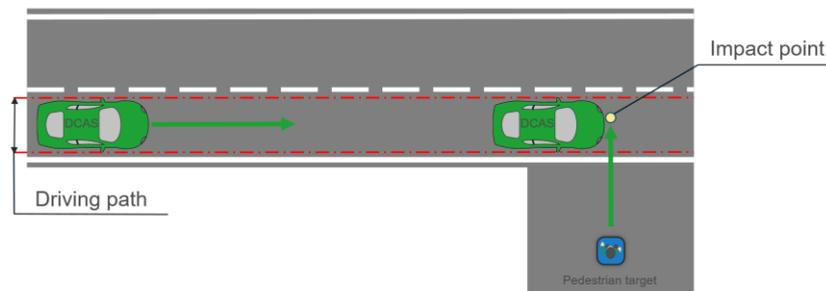
4.2.5.2.10.2. Essai prolongé ; l'essai doit démontrer que le système ne modifie pas de manière déraisonnable la stratégie de contrôle d'une cible piéton qui traverse.
