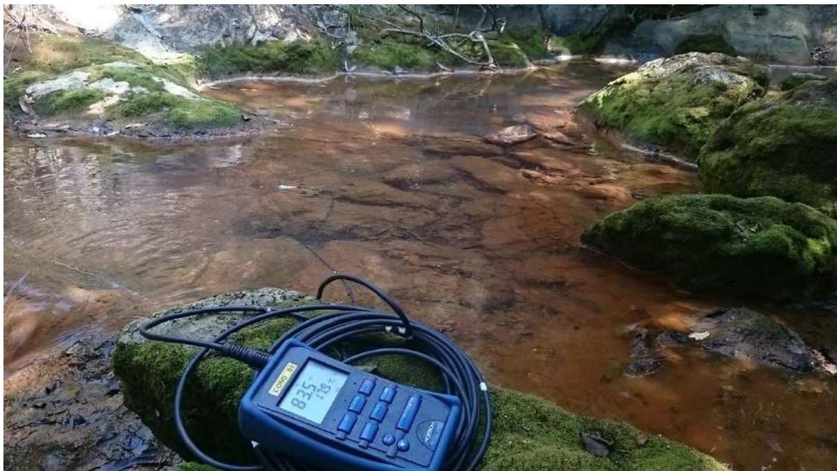
Figura 8 Medida *in situ* de variables fisicoquímicas mediante empleo de sonda multiparamétrica WTW Multi 340.
