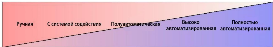
Рис. 1 Спектр функций в системе автоматизации транспортных средств (Flemisch et al., 2008)
