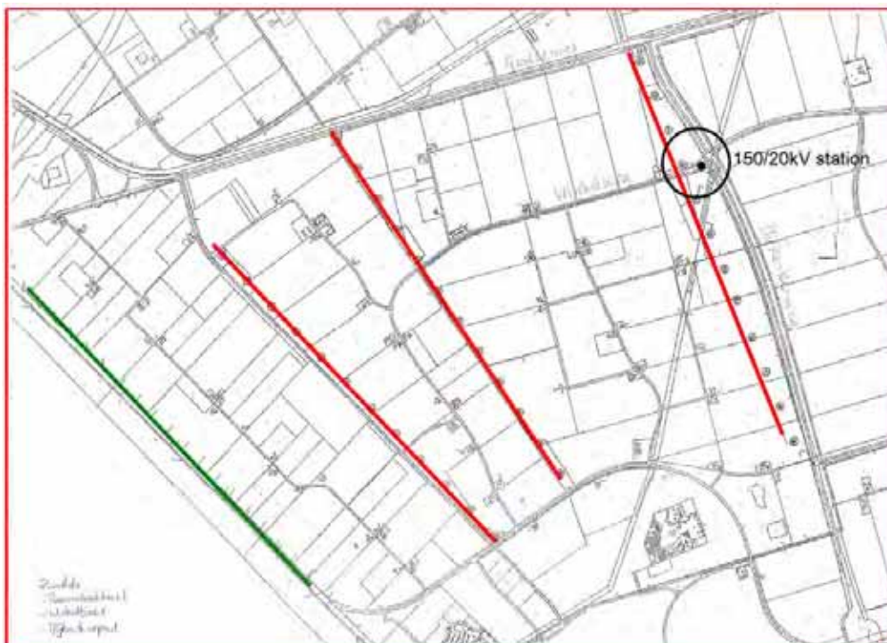
Figuur 1 Drie lijnopstellingen (rood) en het onderstation (150/20kVstation). De groene lijn is de bestaande windturbineopstelling nabij de Eemmeerdijk
