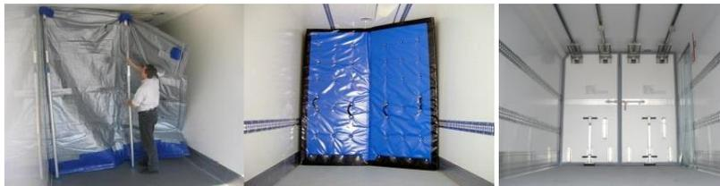
3. При сертификации транспортных средств с мультитемпературным режимом необходимо проводить оценку свойств внутренних разделительных стенок, позволяющих обеспечивать физическую и термическую изоляцию между двумя смежными камерами внутри транспортного средства при перевозке скоропортящихся пищевых продуктов.
