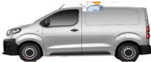
6. Пример № 2: Фургоны серийного производства со встроенной изоляцией и холодильной установкой, частично утопленной в крышу, которая имеет дефлектор:
