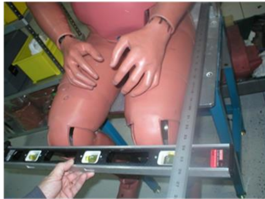
Figure 10 Mesure de la hauteur du mannequin en position assise
