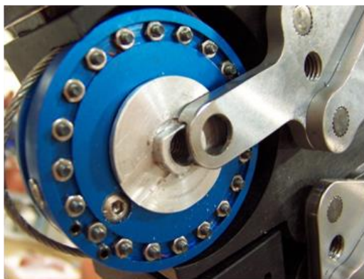
Figure 32 Installation de la poulie amortisseur
