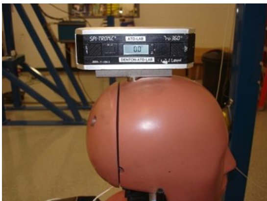
Figure 6 Réglage de l'inclinaison de la tête
