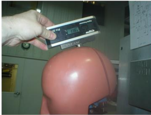
Figure 8 Mesure de la hauteur des cuisses
