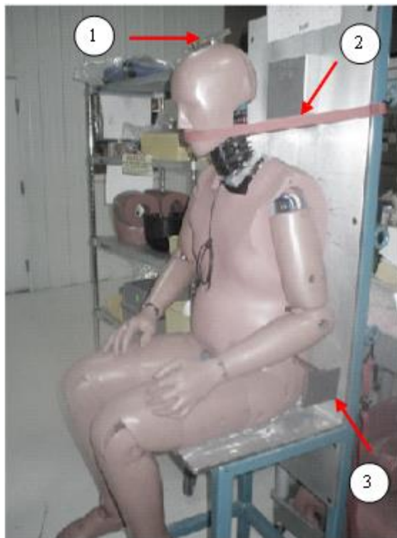
Figure 2 Installation du mannequin sur la chaise de mesure
