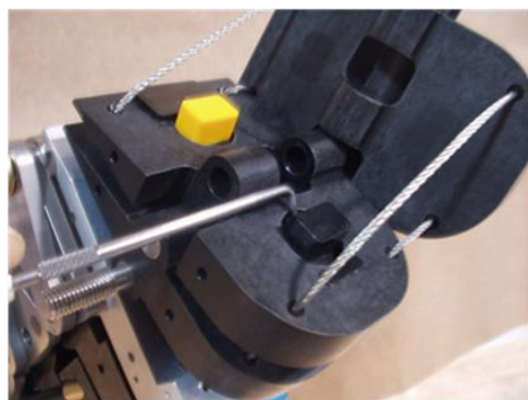
Figure 78 Retrait des amortisseurs des vertèbres C1 à C7 à l'aide d'un crochet pointu
