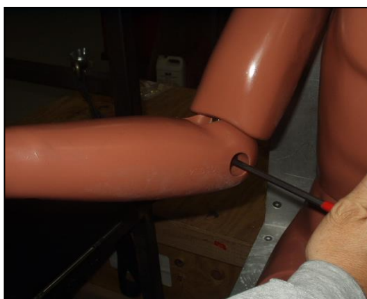
Figure 62 Réglage du coude (rotation transversale de l'avant-bras)
