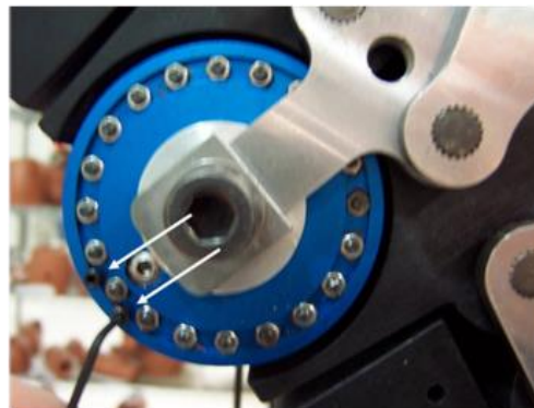
Figure 27 Desserrage des vis de blocage M3
