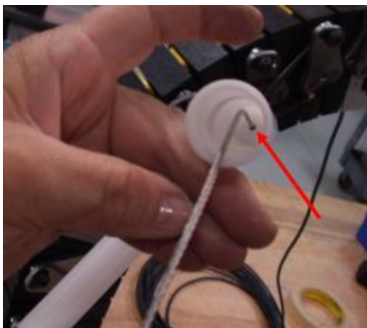
Figure 19 Insertion du câble avant
