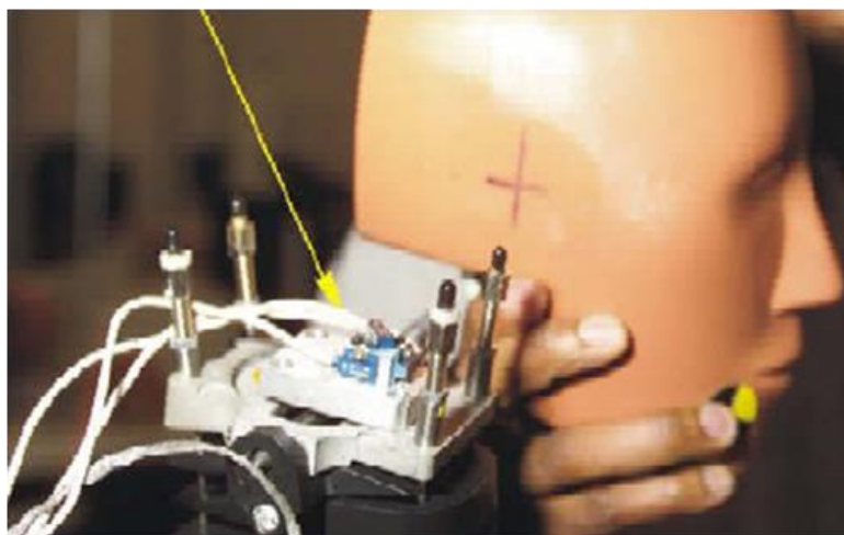
Figure 67 Orientation des accéléromètres de la tête
