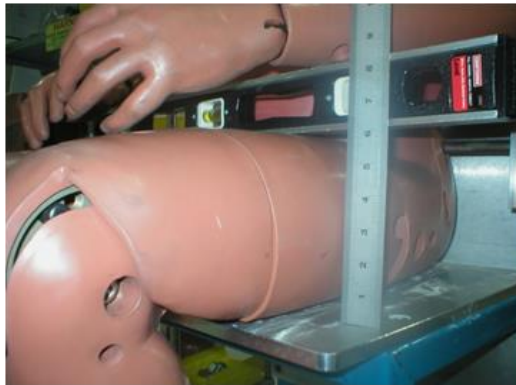
Figure 8 Mesure de la hauteur des cuisses
