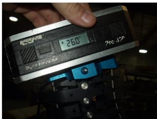
Figure 47 Inclinaison de la plaque d'assemblage occipito-cervicale vers l'arrière
