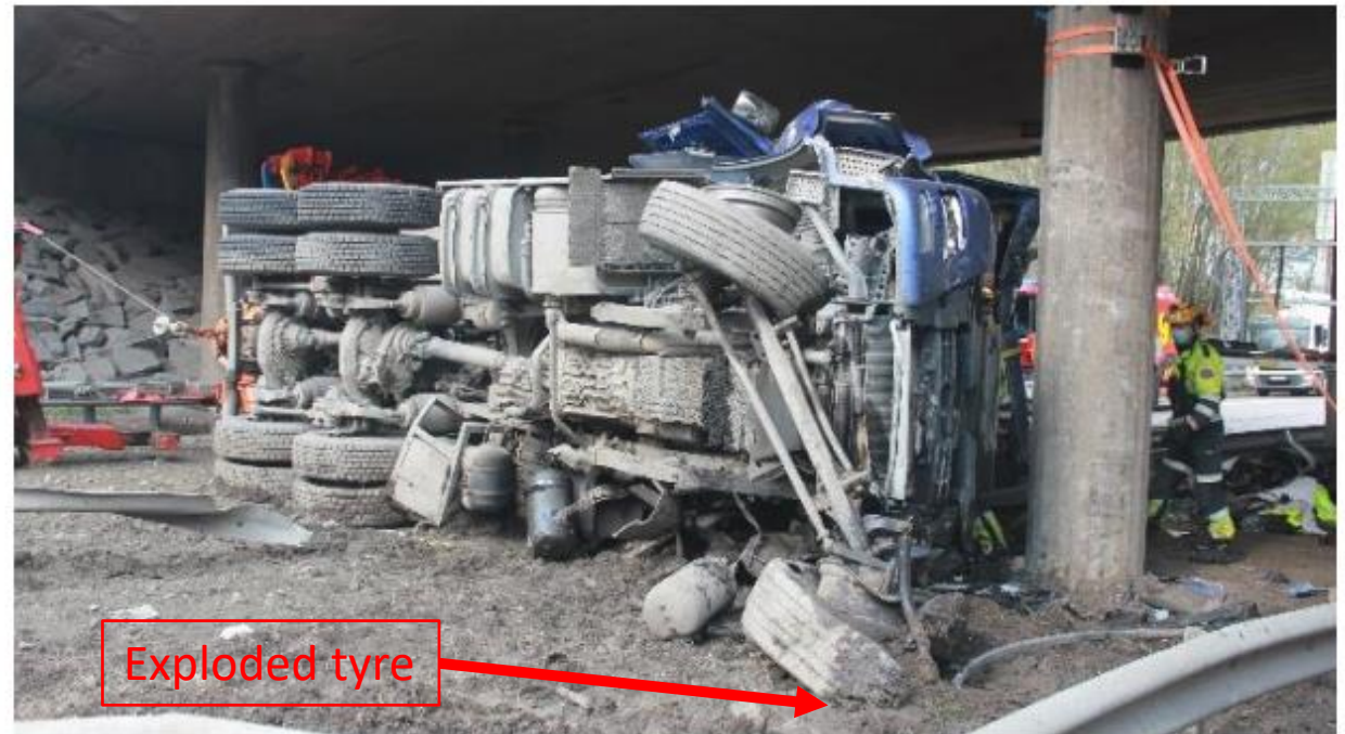
Figur 4: Sluttposisjonen og skadene til lastebilen etter kollisjon med brupilaren som stod i midtdeleeren mellom kjøreretningene. Foto: SHK
