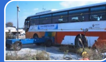
[50km/h HDV-950kg MDB side crash test]
