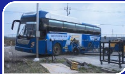
[54km/h 27° HDV-1368kg MDB side crash test]
