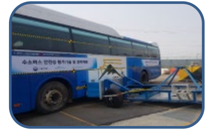
<54km/h 27° HDV-1100kg MRB side crash test>
