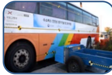
<50km/h HDV-950kg MDB side crash test>
