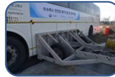
<50km/h HDV-1100kg MRB side crash test>
