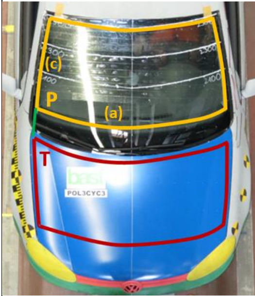
Рис. 14 Боковые границы зоны контрольного испытания накладки рамы
