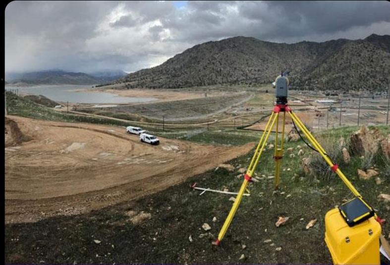
Мониторинг деформаций в настоящее время в основном выполняется вручную инженерами, которые должны выезжать на место, например, в мастерскую, плотину или шахту и, в зависимости от размера конструкции и площади, проводить дни или недели, измеряя уровень деформации вручную.
