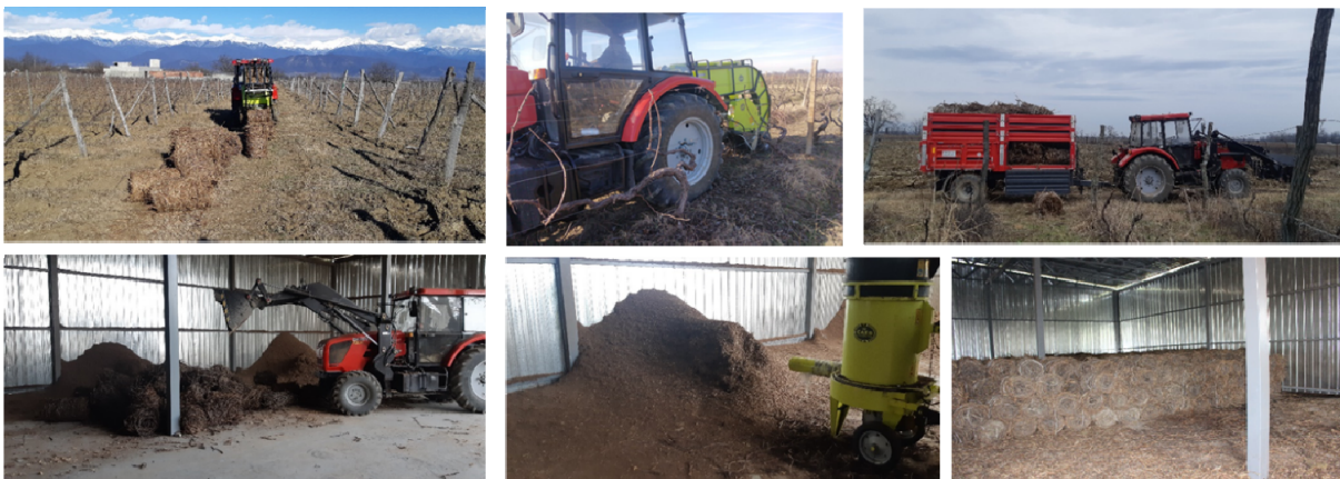
სურათი 11: ბიომასის შეგროვების, ტრანსპორტირების, შენახვისა და დაქუცმაცების პროცესის ასახვა
