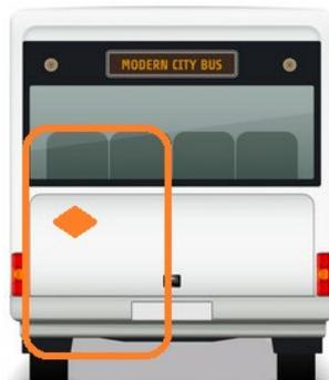
Рисунок 11.2- Размещение на транспортном средстве категории М2 и М3
