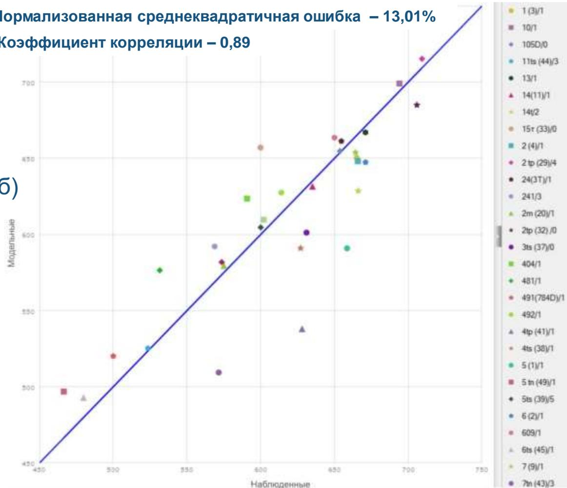
График сходимости модельных и наблюдаемых напоров подземных вод Приташкентского ТГВГ до (а) и после (б) стационарной калибровки
