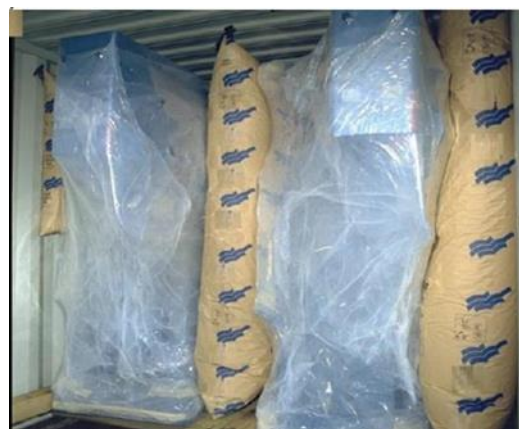
Figure 7.4913 Colis de forme irrégulière immobilisés à l'aide de sacs d'arrimage
