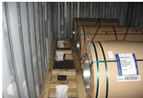
Figure 7.40 Dispositif d'immobilisation placé contre l'entourage Figure 7.41 Dispositif d'immobilisation placé contre l'entourage
