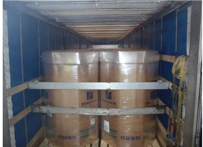
Figure 7.15 Traverses servant à l'immobilisation
