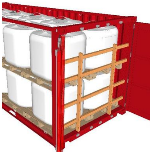
Figure 7.49 Barres d'accorage insérées dans les encoches d'accorage et soutenues par des montants placés contre les murs
