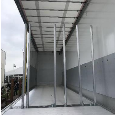
Figure 7.14 Montants fixés au sol
