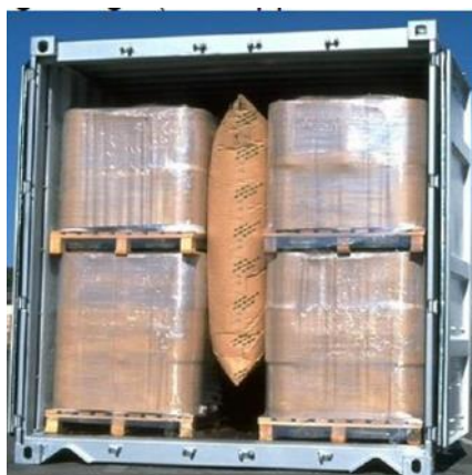
Figure 7.912 Espace rempli par un sac d'arrimage centra
