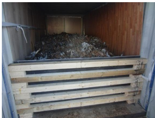
Figure 7.5574 Engin de transport chargé rempli de ferraille doté d'une doublure au niveau des parois et d'une barrière de porte
