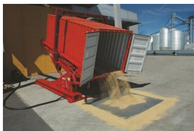
Figure 7.84 Décharge sur trémie
