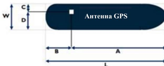
Обозначения, касающиеся параметров  $W$ ,  $L$ ,  $A$ ,  $B$ ,  $C$  и  $D$  судна.
