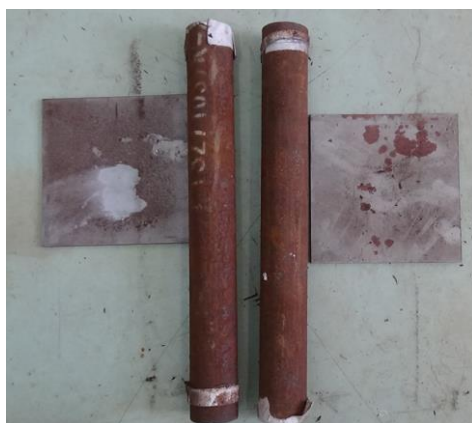
Figure 3. Plaque témoin et tube après l'épreuve d'amorçage de la détonation de l'ONU (épreuves de la série 2)
