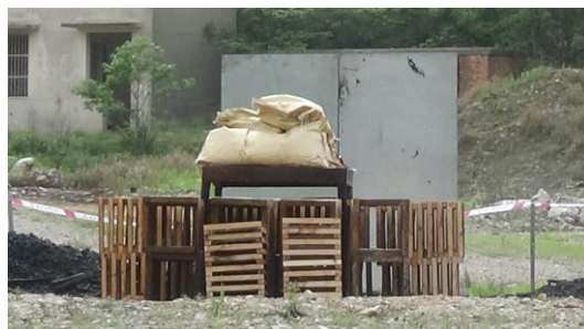
Figure 6. Dispositif de l'épreuve du feu extérieur (7 colis de N-nitroaminoimidazole ont été placés sur une grille métallique, et des copeaux de bois ont été introduits entre les lattes de bois et imprégnés de kérosène)
