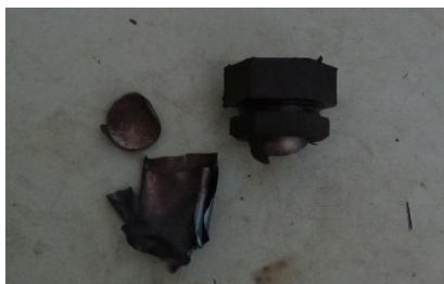
Figure 2. Tube à essai après l'épreuve de Koenen (épreuves de la série 1), type de fragmentation « F »
