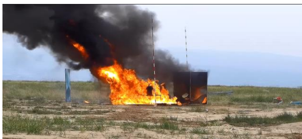
Figure 3. Réservoir de stockage cylindrique en acier inoxydable de 20 L lors du deuxième essai 6 c)
