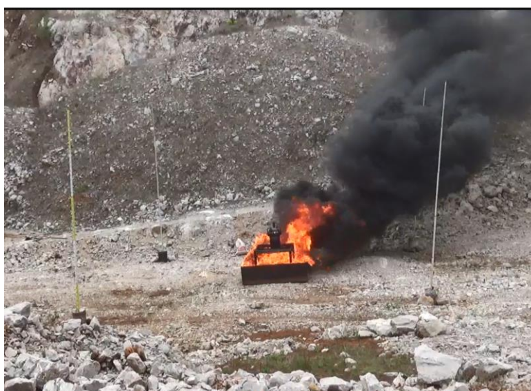
Figure 1. Réservoir de stockage cylindrique de 20 L en acier inoxydable lors de l'essai 6 c)
