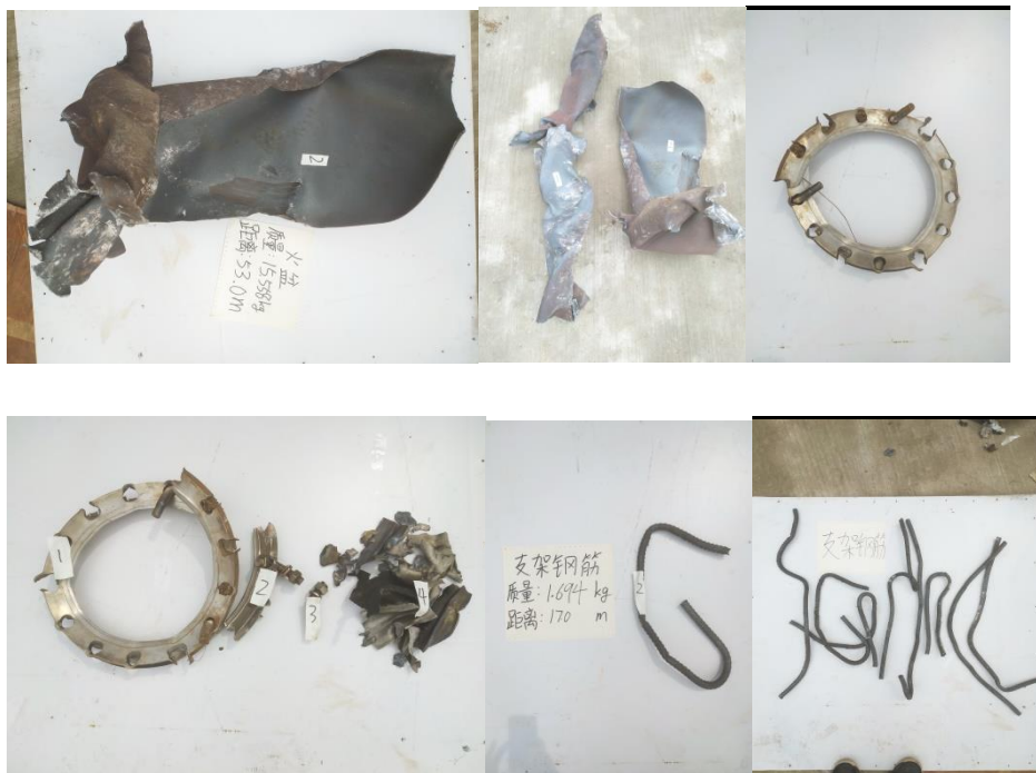
Figure 2. Fragments du réservoir après l'essai
