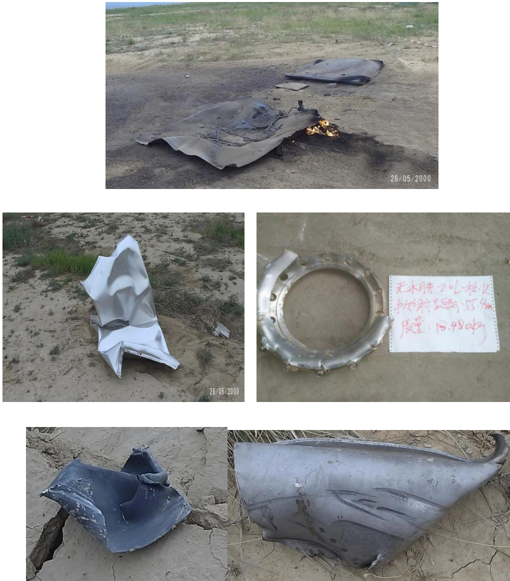
Figure 4. Fragments du réservoir après l'essai
