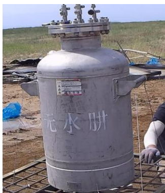
Figure 8. Hydrazine anhydre conditionnée dans un réservoir cylindrique de 120 L en acier inoxydable
