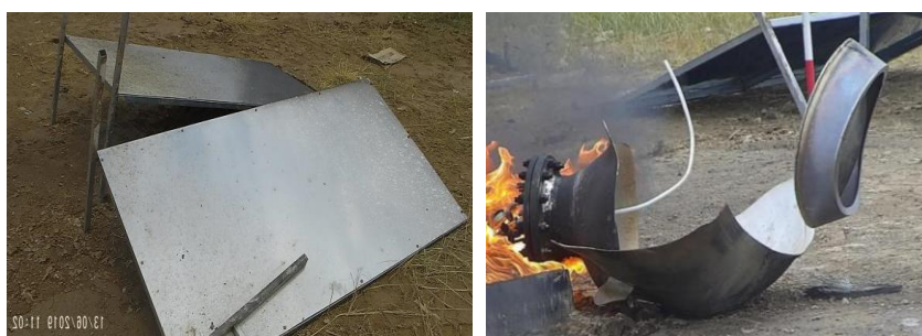
Figure 10. La plaque témoin et le réservoir après l'essai
