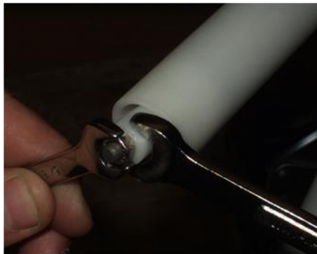
Рис. 43 Фиксация регуляторов натяжения подпружиненного троса
