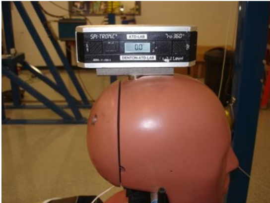
Рис. 6 Установка муляжа головы на требуемый угол
