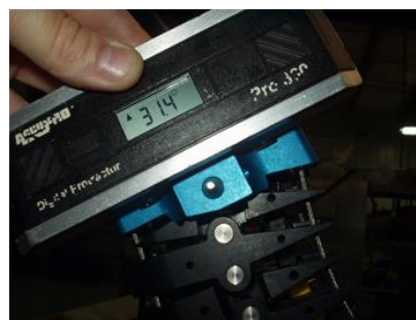
Рис. 45 Наклон пластинчатого сочленения, имитирующего затылочный мышечлок, вперед
