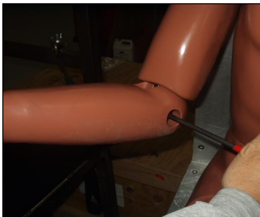
Рис. 62 Регулировка болта локтевого шарнира
