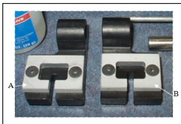
Рис. 80 Установочные приспособления для прокладок шейного отдела А — для позвонков C2, C4 и C6; В — для позвонков C3, C5 и C7
