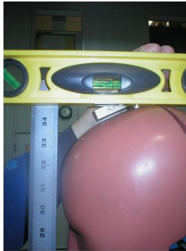
Рис. 11 Измерение высоты расположения левой коленной чашечки при согнутом колене
