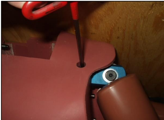
Рис. 60 Регулировка плечевого шарнира
