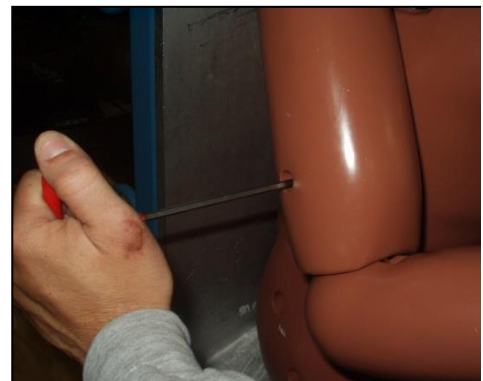
Рис. 63 Регулировка болта поворота запястья
