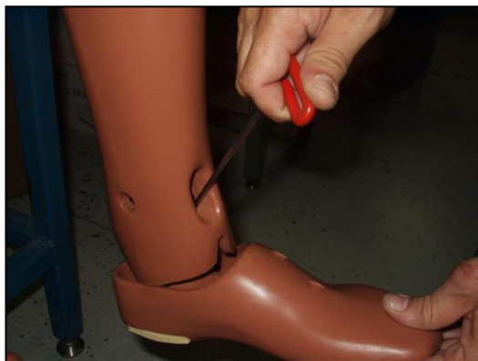
Рис. 66 Регулировка голеностопного шарнира
