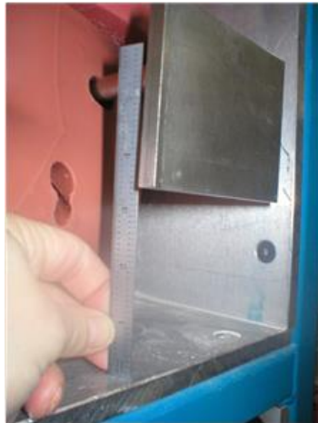
Рис. 6 Измерение угла наклона приспособления для определения точки Н
