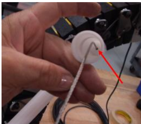
Рис. 21 Регулятор натяжения троса заподлицо с торцом втулки
