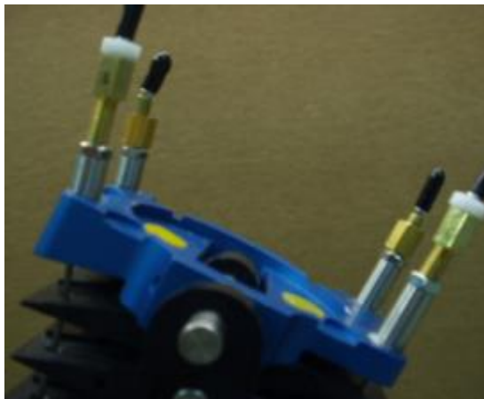
Рис. 49 Регуляторы натяжения троса демпфера
