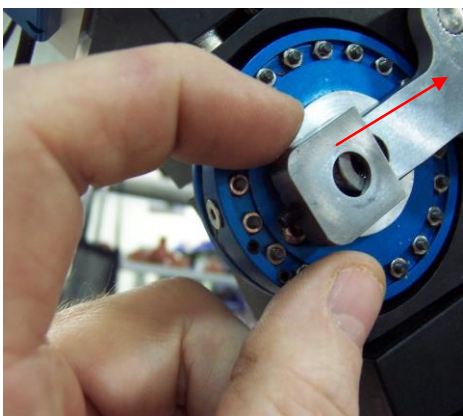
Рис. 14 Установочный винт зажима демпфера
