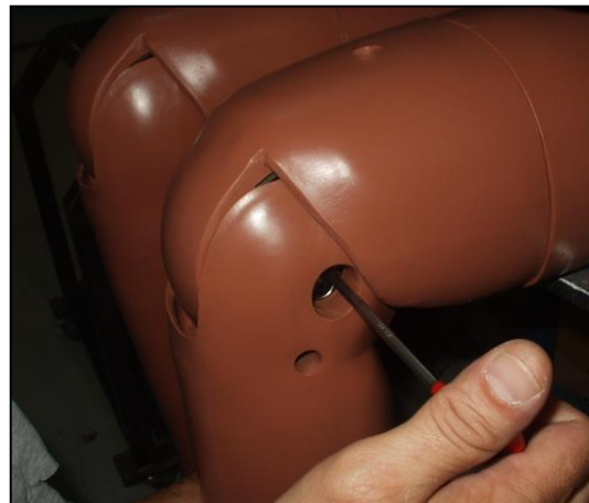
Рис. 65 Регулировка коленного шарнира
