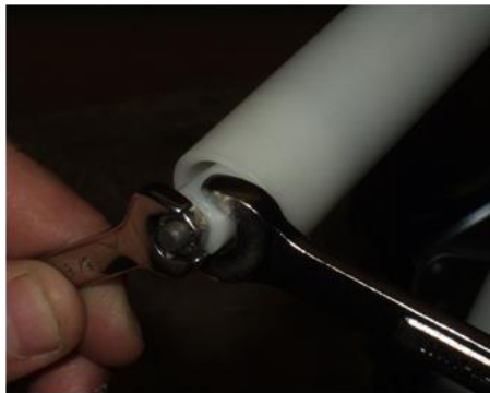
Рис. 43 Фиксация регуляторов натяжения подпружиненного троса
