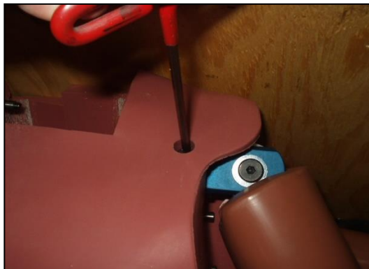
Рис. 60 Регулировка плечевого шарнира
