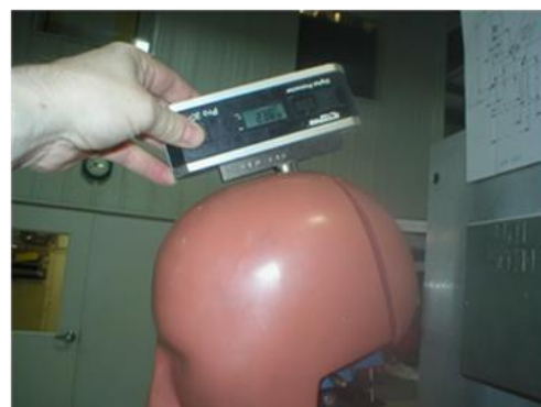
Рис. 7 Измерение углового положения нивелира муляжа головы
