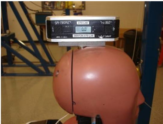
Рис. 6 Установка муляжа головы на требуемый угол
