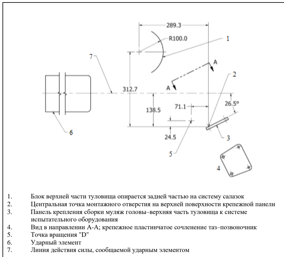
Рис. 2 Основные размеры механизма салазок (в мм)
