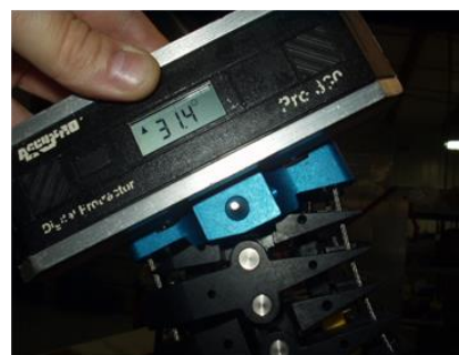
Рис. 45 Наклон пластинчатого сочленения, имитирующего затылочный мыщелок, вперед
