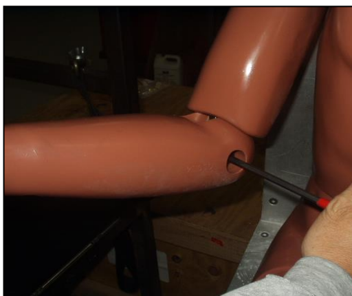
Рис. 62 Регулировка болта локтевого шарнира
