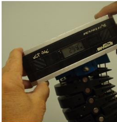
Рис. 53 Выставление угла наклона пластинчатого сочленения, имитирующего затылочный мышцелок
