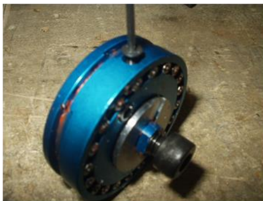
Рис. 33 Извлечение заглушки маслозаправочного отверстия
