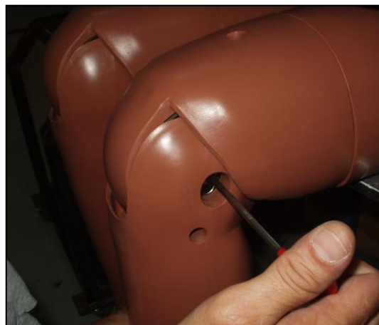
Рис. 65 Регулировка коленного шарнира
