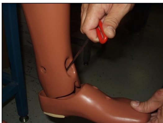
Рис. 66 Регулировка голеностопного шарнира
