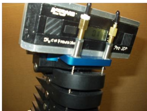
Рис. 51 Выставление латерального угла пластинчатого сочленения, имитирующего затылочный мышцелок
