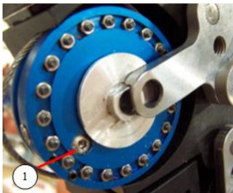
Рис. 9 Выставление регулировочного винта демпфера
