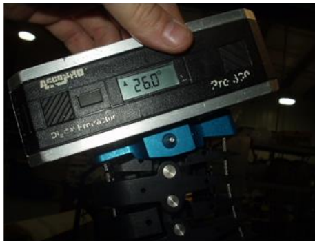
Рис. 47 Отклонение пластинчатого сочленения, имитирующего затылочный мыщелок, назад
