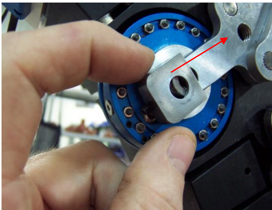
Figure 12 Installation du support de serrage de la poulie amortisseur
