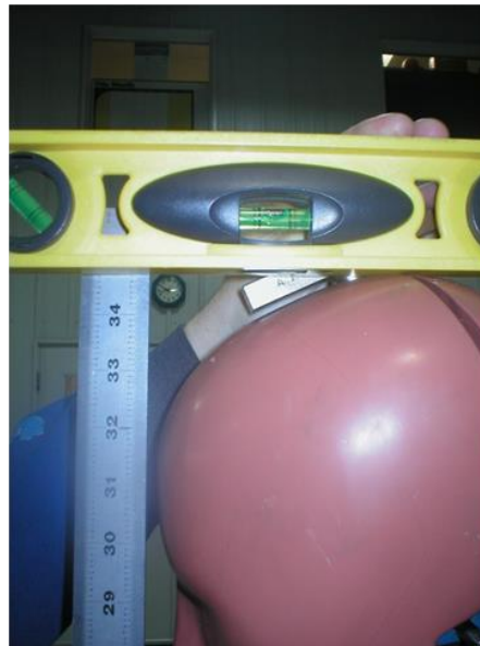
Figure 11 Mesure de la hauteur de l'axe de rotation du genou gauche
