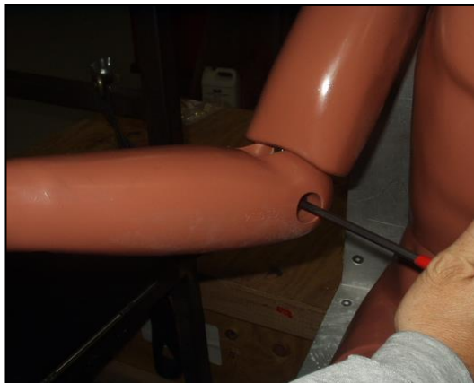
Figure 62 Réglage du coude (rotation transversale de l'avant-bras)
