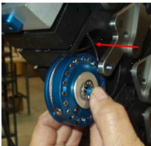
Figure 12 Installation du support de serrage de la poulie amortisseur
