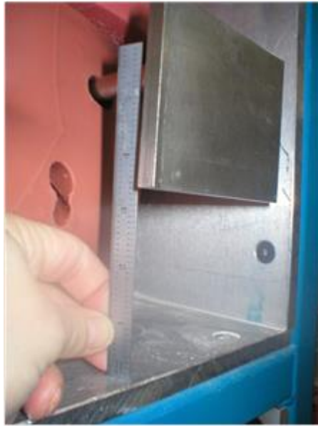
Figure 6 Mesure de l'angle de la cale de positionnement du point H
