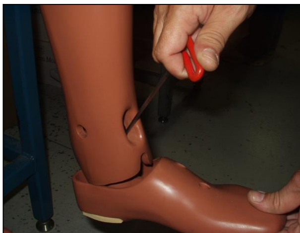
Figure 66 Réglage de la cheville
