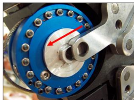
Figure 29 Retrait de la poulie amortisseur
