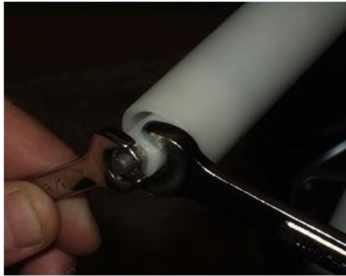
Figure 43 Blocage des tendeurs à ressort
