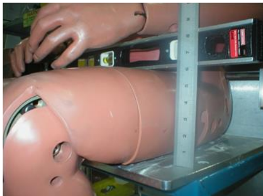
Figure 8 Mesure de la hauteur des cuisses
