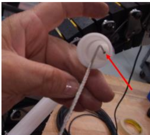
Figure 19 Anterior Spring Cable Insertion
