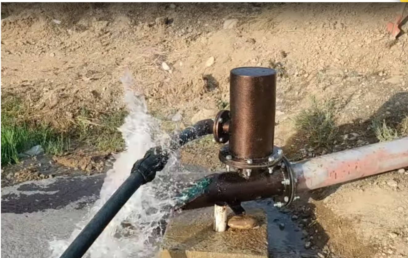
Улучшенный гидротаран Рогозина. Фото: ИП Рогозин
