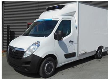
*Пример № 4: Фургоны серийного производства со встроенной изоляцией и установкой, монтируемой под шасси или в моторном отсеке.*
