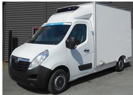
*Пример № 4: Фургоны серийного производства со встроенной изоляцией и установкой, монтируемой под шасси или в моторном отсеке.*
