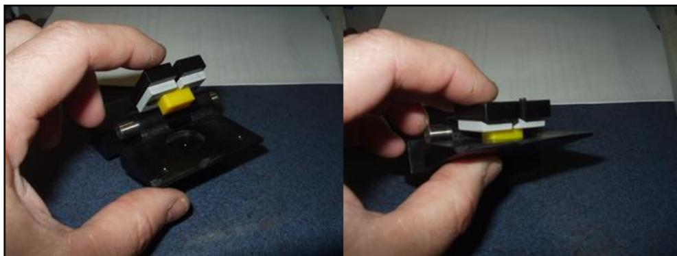
**Retirer les deux vis à tête cylindrique M2,5 qui retiennent la broche T1 au niveau de l'articulation C7-T1 (fig. 82). Faire glisser la broche T1 hors de l'articulation vertébrale (fig. 83) et la mettre de côté avec les deux vis à tête cylindrique M2,5-0,45 x 8 pour une réinstallation ultérieure. »**
