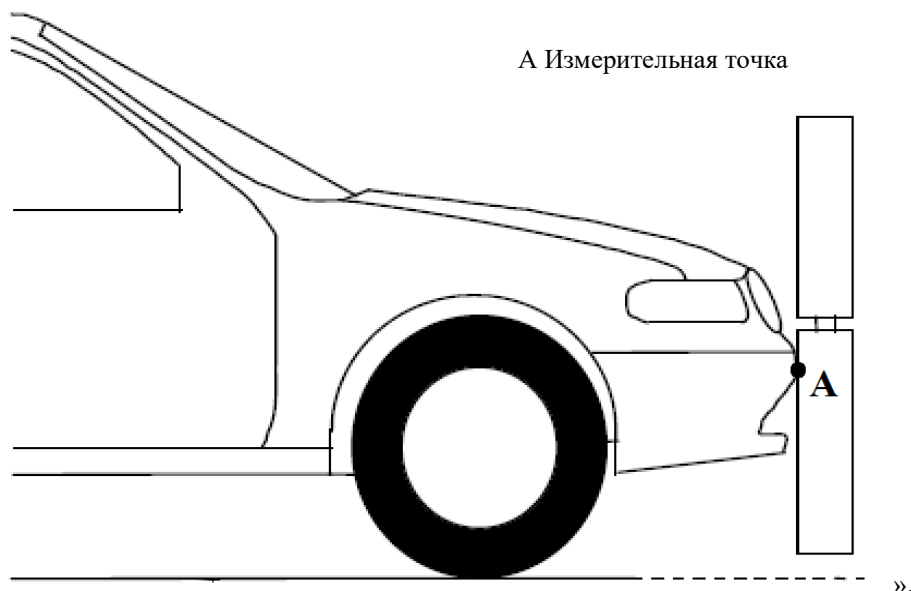
Рис. 6В Измерительная точка в вертикальной продольной плоскости, проходящей через центральную ось ударного элемента в виде модели ноги (см. пункт 3.21.2)
