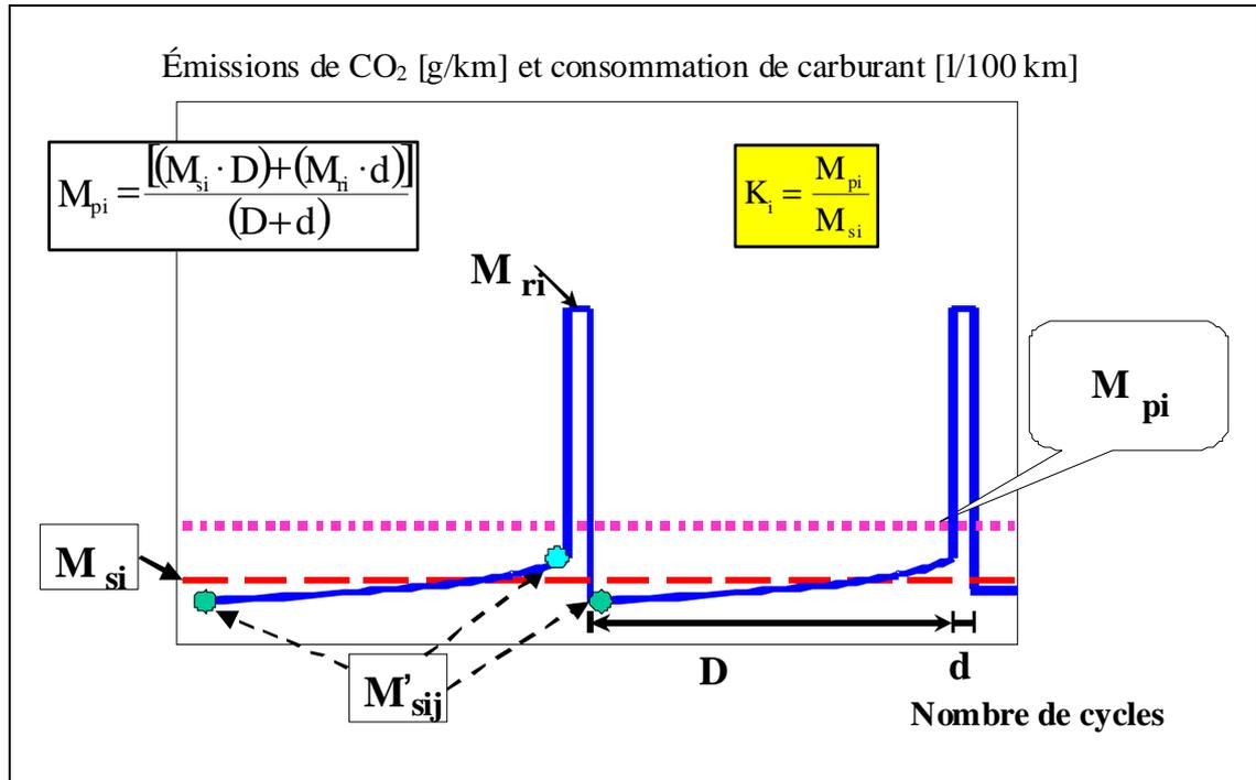
3.3.1 Calcul du coefficient de régénération K pour les émissions de CO<sub>2</sub> et la consommation de carburant (i) considérées
