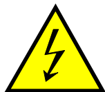
Figure 1 Marquage de l'équipement à haute tension
