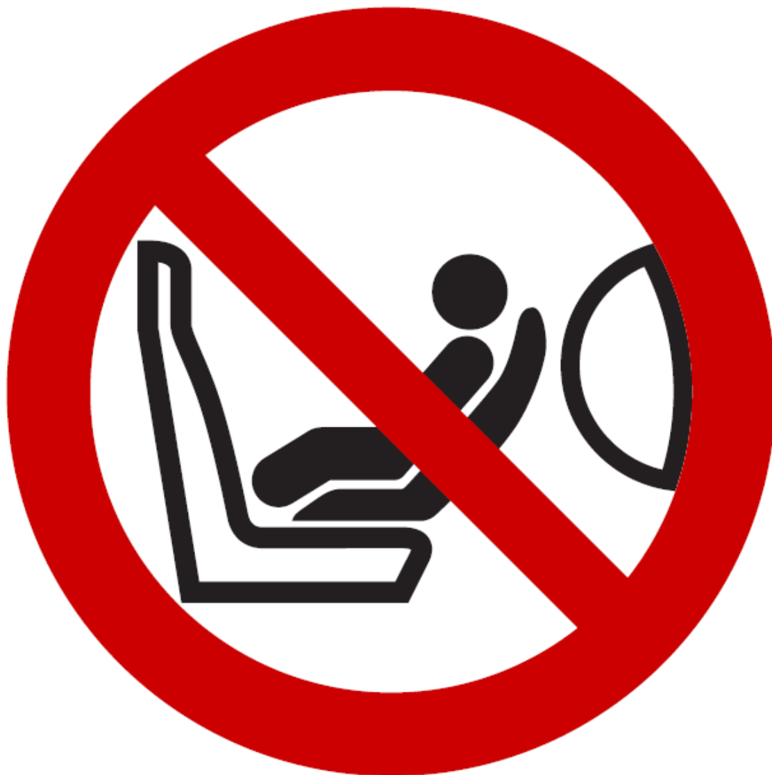
Рис. В Используемая пиктограмма в соответствии с ISO 2575:2004 – Z.01, внешний диаметр которой должен составлять не менее 38 мм
