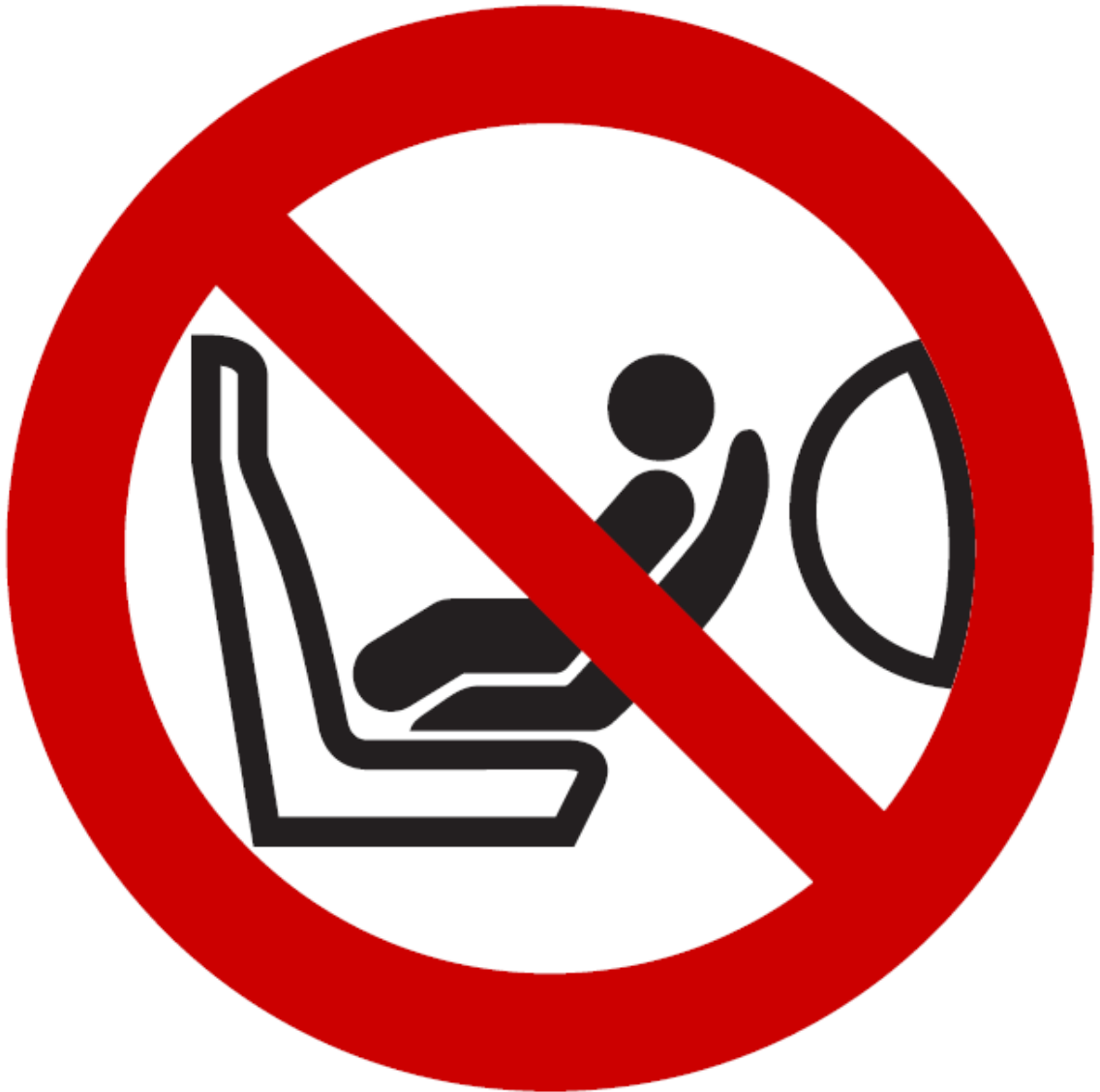
Figure B Pictogramme à utiliser, conforme à la norme ISO 2575:2004 – Z.01, dont le diamètre extérieur doit être d'au moins 38 mm
