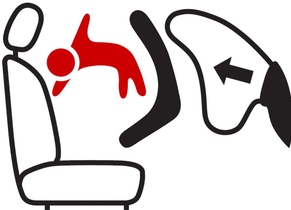
Figure C Pictogramme à utiliser pour illustrer le danger en cas de déploiement du coussin gonflable, qui doit mesurer 40 mm de large et 28 mm de haut ou être de dimensions proportionnellement plus grandes
