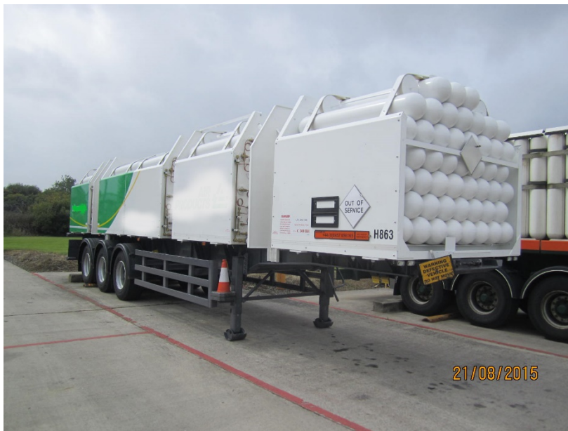
Véhicule-batterie construit avec des bouteilles en acier sans soudure
