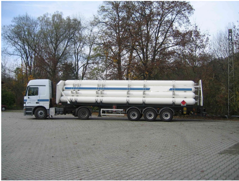
Véhicule-batterie construit avec des tubes en acier sans soudure
