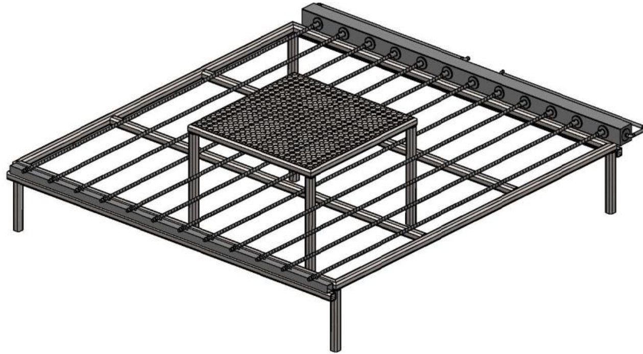
Figure 1: Appareillage à combustible gazeux pour les épreuves 6 c) proposé par les États-Unis
