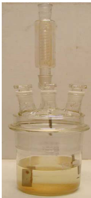
Figura 37.4.2: REACTOR PROVISTO DE REFRIGERANTE CON REFLUJO
