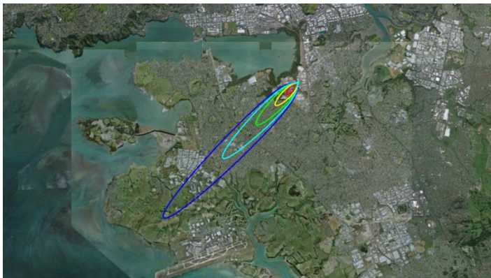
Рис. 1 Пример непрерывной утечки хлора
