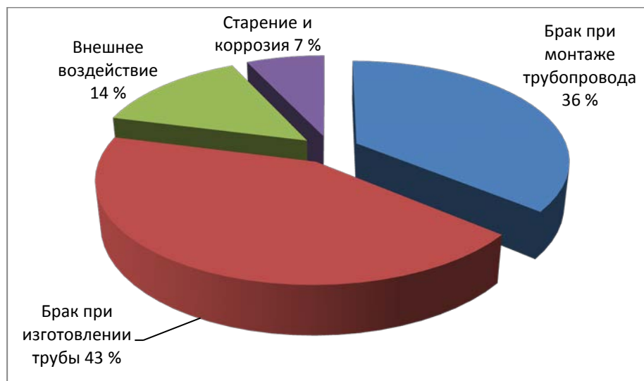
Рисунок 2.6. Причины аварий на магистральных трубопроводах.
