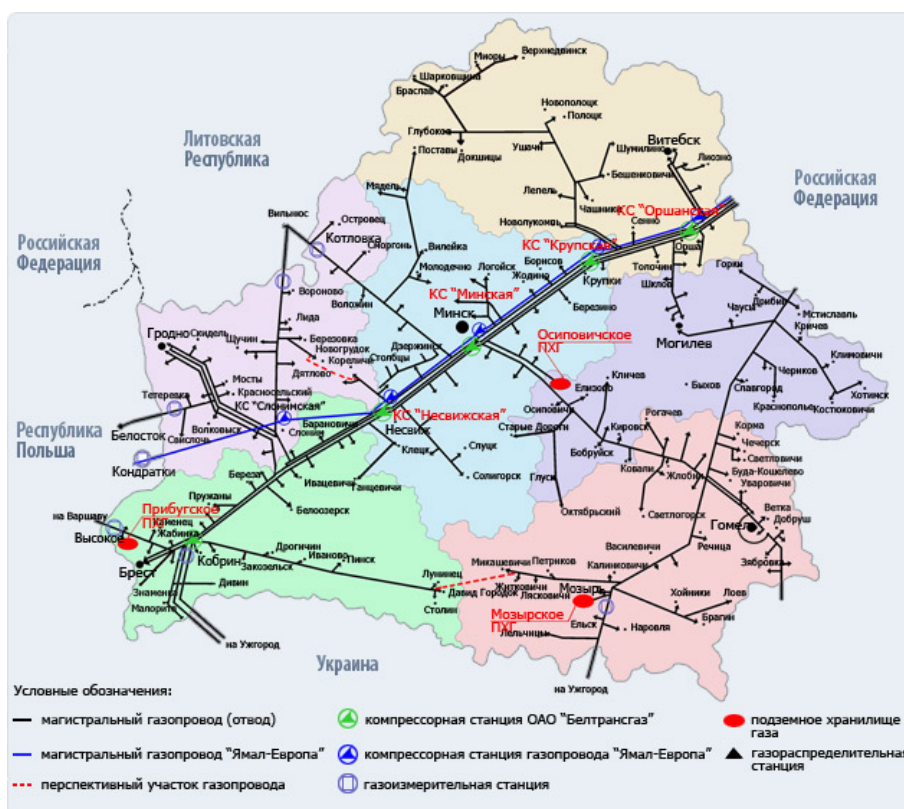
Рисунок 2.1. Система магистральных газопроводов ОАО «Газпром трансгаз Беларусь».
