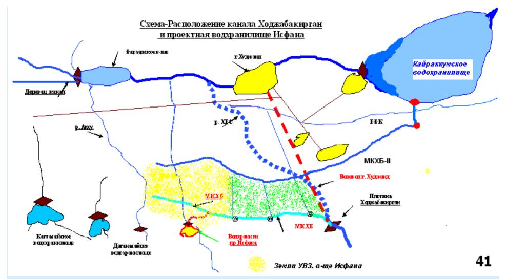
Строительство селехранилище Исфана будет предназначено для многолетнего регулирования стока с целью максимальной отдачи оросительной воды для улучшение водообеспеченности староорошаемых земель на хвостовой части канала Ходжабакирган на площади 4100 га, трансформации паводкового стока для защиты от затопления и размыва сельхозугодий, населенных пунктов, автомобильных дорог, складирования твердой фазы стока реки.
