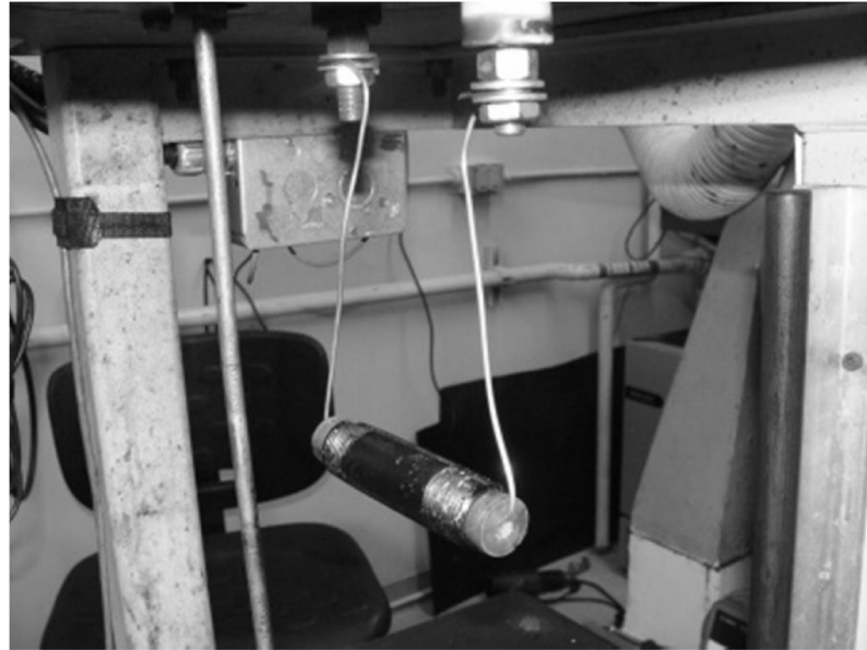
الشكل 2-8-18: خلية اختبار مركبة بشكل أفقي تحت غطاء وعاء الضغط (موصلات نحاسية موصولة بقطبين مثبتين بالوعاء)
